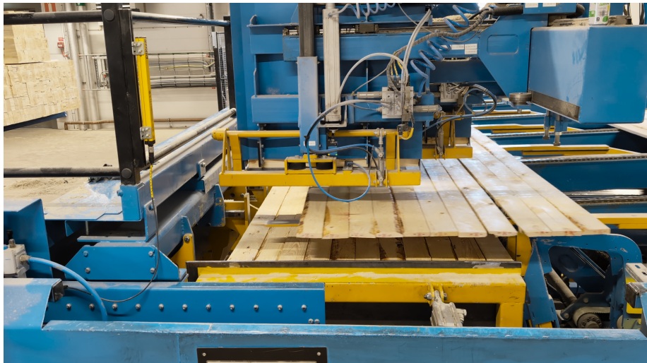
Figur 6: Paketering av plankor till färdiga paket.
