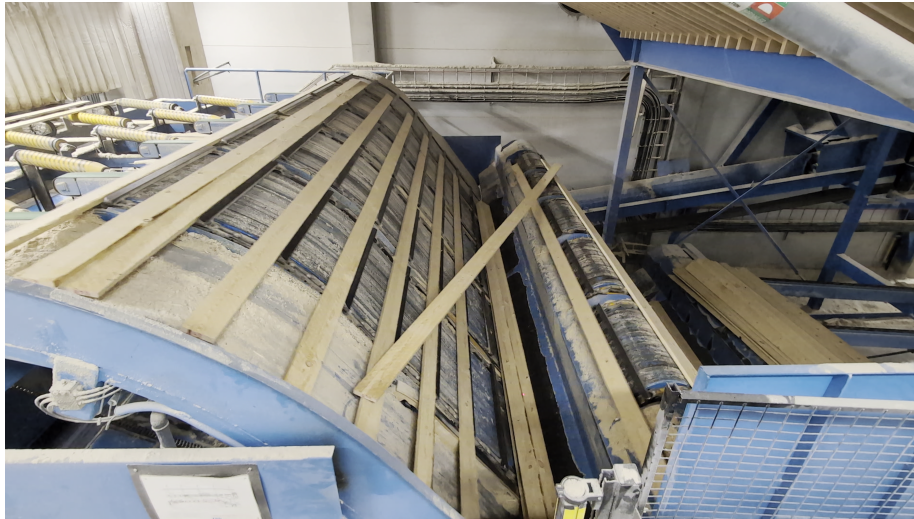
Figur 19: En planka som under processens gång roterats så att den hamnar fel. Detta anses vara en dynamisk effekt och är därför ingenting som modellen tar hänsyn till.
