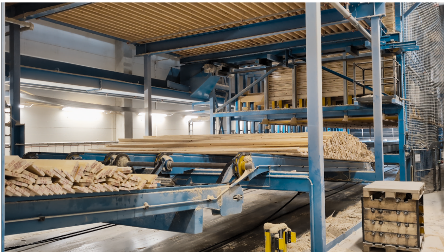
Figur 2: Paket som ligger och väntar på att köras igenom processen. I bakgrunden ses ett paketlager där plankor i varje fack har samma dimension och kvalitet.
