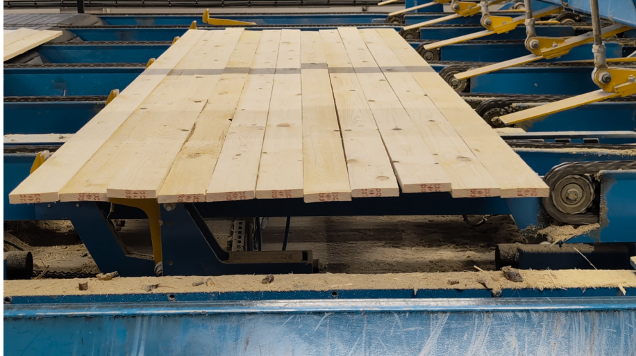
Figur 5: Separation av plankor inför paketering.
