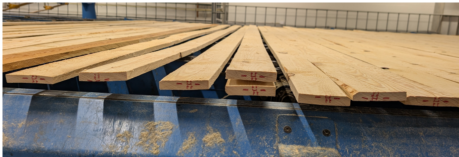
Figur 12: Dubbel bit som gått vidare till nästa steg i processen.
